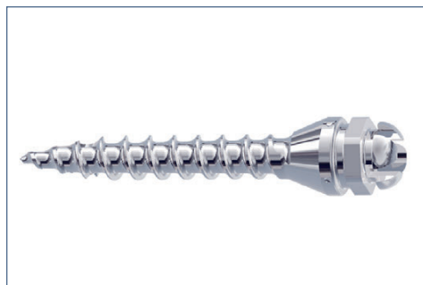
Abb. 2 Der tomas®-pin SD besteht aus dem selbstbohrenden Gewinde (Ø 1,6 mm) mit konischem Tiefenstopp, der fließend in den konusförmigen Gingivakragen übergeht. Der Kopf mit seinem 22er Kreuzslot bietet zahlreiche Kopplungsmöglichkeiten.
