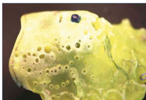
Abb. 11 Blasenbildung im Kunststoff durch Verarbeitungsfehler. Das Modell wurde nicht gewässert und es traten Siedebblasen auf.
